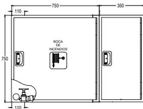
Armário de extintor 6/9/12 kg modelo STAR. Dimensões: 750 x 350 x 215 mm
