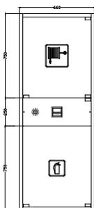
Conjunto fabricado numa só peça composto de BIA IBIGLASS + Alarme + arm. de extintor duplo.
