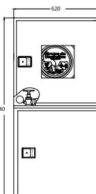
Armário para dois extintores modelo RIASTAR. Dimensões: 620 x 620 x 250 mm
