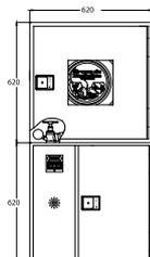
Arm. Ext. + Alarme para sistemas verticais modelo RIASTAR. Dimensões: 620 x 620 x 250 mm
