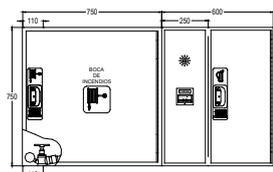
Armário de extintor + alarme fabricado numa só peça modelo STAR. Dimensões: 750 x 600 x 215 mm
