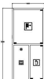
Conjunto fabricado numa só peça composto de BIA IBIGLASS + arm. de extintor + módulo de Alarme.
