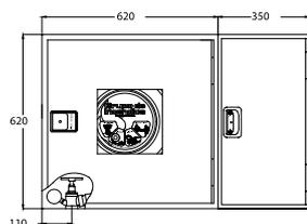
Armário de extintor 6 Kg modelo RIASTAR. Dimensões: 620 x 350 x 250 mm
