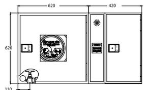
Armário de extintor + alarme fabricado numa só peça modelo RIASTAR. Dimensões: 650 x 420 x 250 mm
